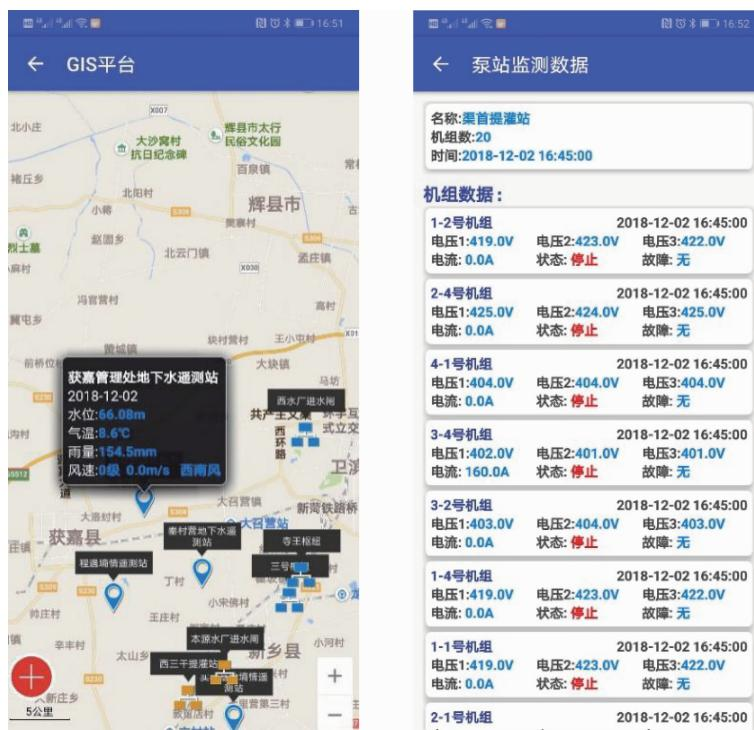
图 6 遥测站与泵站查询界面
