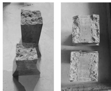
(a) 不带预制缝混凝土断面 (b) 带预制缝混凝土断面
