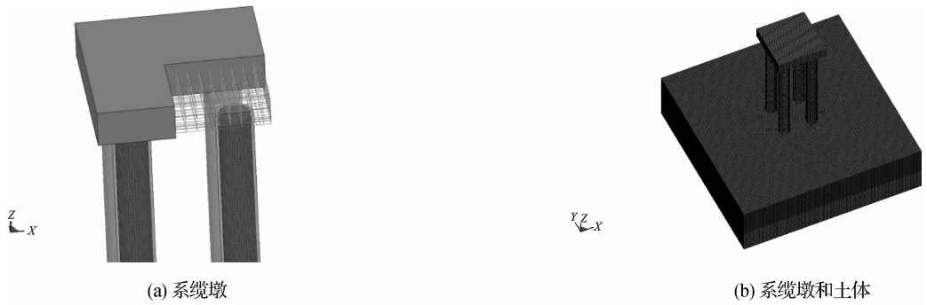
图 5 系缆墩有限元模型
