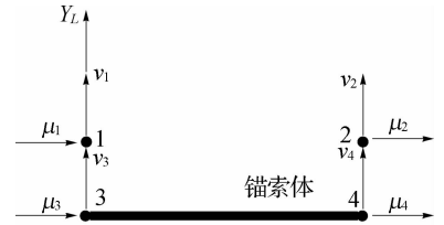
图1 锚索单元几何模型 [10]
