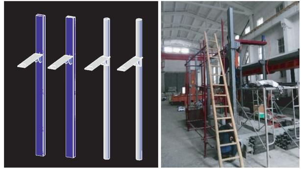
图1 组合长柱模型和试验现场
