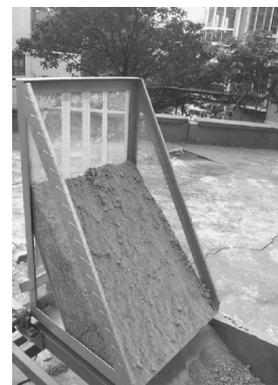
图4 试验测定的休止角
