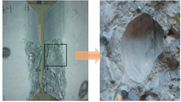
图 4 试件破坏形态和空洞
