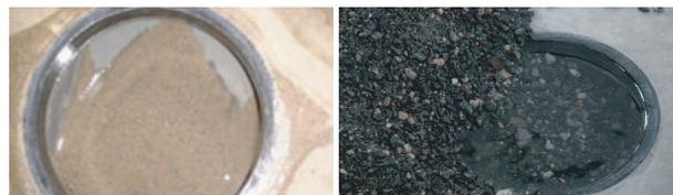
(a) 中心出水环处粉沙淤积 (b) 中心出水环处粗砂淤积
