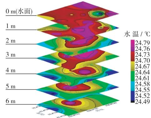
图4 金牛山水库水温分层切片
