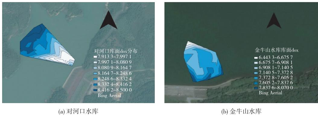
图2 对河口水库和金牛山水库水面溶解氧含量分布
