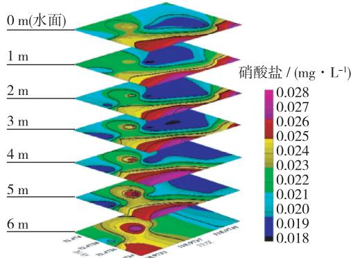
图3 金牛山水库硝酸盐分层切片
