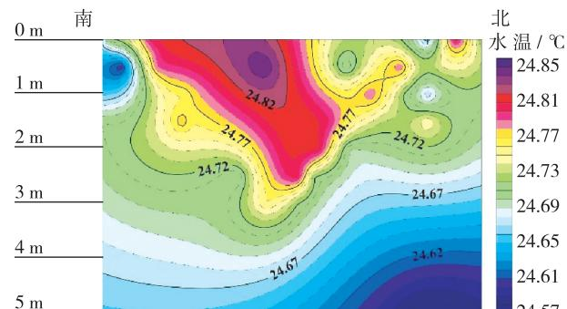
图5 金牛山水库温度纵向剖面
