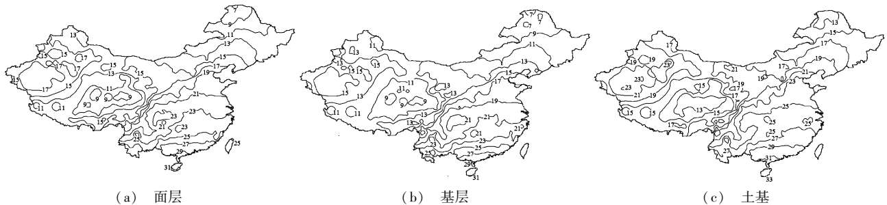
图 1 全国陆域面层、基层及土基疲劳寿命基准等效温度 \bar{T}_{\text{pef}} 等值线 (单位: °C)
