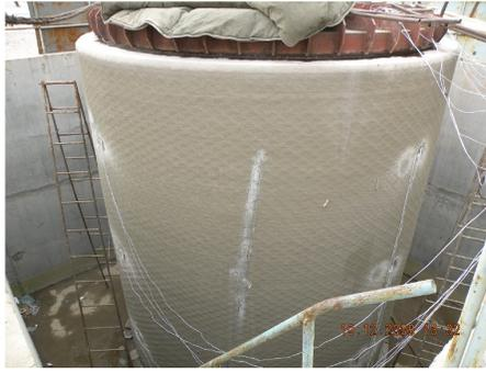
图5 内水压加载装置
