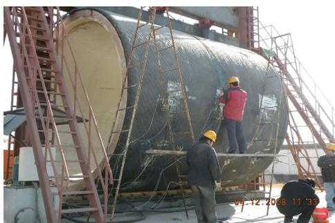
图3 断丝管加载装置
