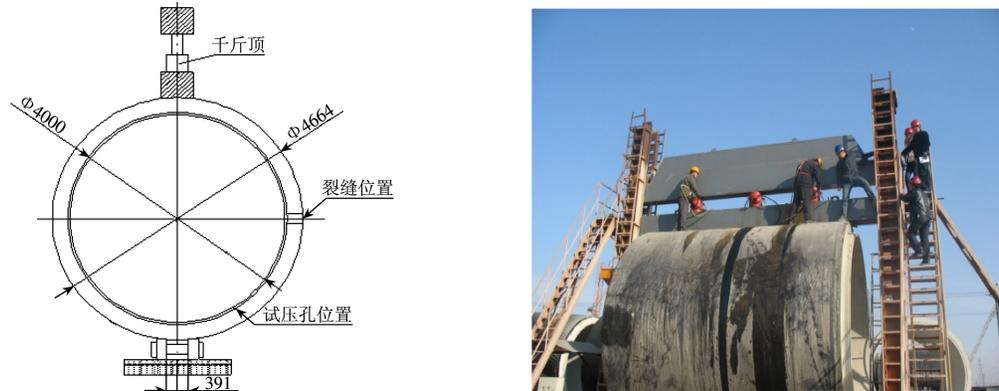
图 2 裂缝位置及加载装置图
